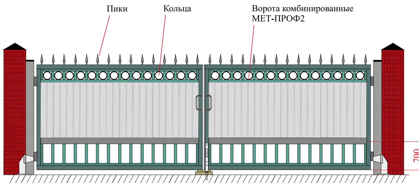
Распашные ворота могут быть изготовлены с декоративными элементами, например с пиками, кольцами, а также выполнены в комбинированном виде из обрешетки и профилированного листа.
